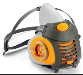
VULCANO è una semimaschera di taglia universale conforme alla norma Europea EN 140:1998, in accordo alla Regolamento UE 2016/425, dotata di due raccordi rapidi a baionetta, per filtri serie 2000, idonea per la protezione da polveri sia grossolane che sottili, da gas e vapori organici, inorganici, acidi e combinazioni di gas e polveri.
